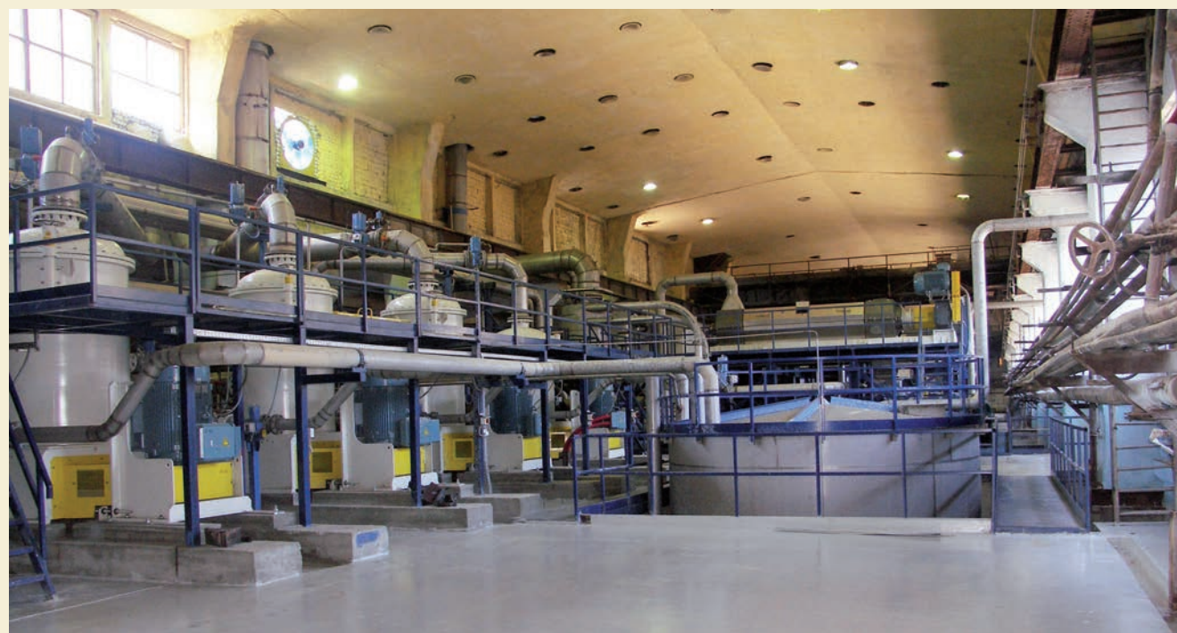
В цехе термомеханической массы производится полуфабрикатное сырье, позволяющее исключить дорогостоящую целлюлозу из производственного процесса.
